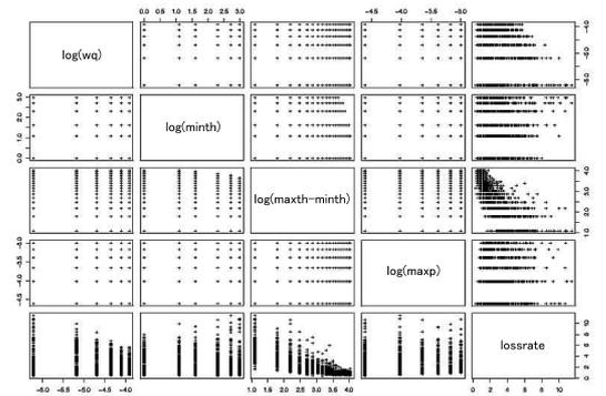
図3 REDのパケット棄却率に関する多変量相関図 (変数変換後)
