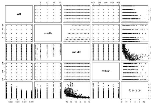
図2 REDの制御パラメータとパケット棄却率に関する多変量相関図
