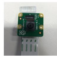
Figure 9: Camera Module v2
