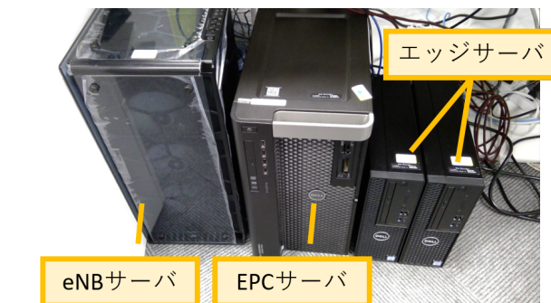
図 9: 実験ネットワーク：eNB、EPC、エッジサーバー
