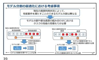
モデル分割と資源割当を最適化する手法 RAMPA の提案 RAMPA: DL モデルの分割と資源割当の双方を最適化することで 将来のタスクが必要とする資源の割当を最小化する手法 モデル分割と割当資源の組み合わせに基づく スループット・実行時間の見積もり • 将来のタスクに対する重要度に基づいたコストを定義 RA-CNP と同様に、高性能な資源とその間の経路のコストを高く設定 性能要件を満たしながら割当資源のコストを最小化できる モデル分割と資源割当の組み合わせを決定する最適化問題を定義
