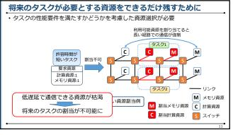
将来のタスクが必要とする資源をできるだけ残すために • タスクの性能要件を満たすかどうかを考慮した資源選択が必要 許容時間が長いのでより 離れた資源を割当 タスク1 許容時間が長いタスク 許容時間が長いタスク C M M 資源割当 要求資源 要求資源 С C М 計算資源:1 メモリ資源:1 計算資源:1 メモリ資源:1 **M** メモリ資源 性能要件を考慮する資源割当例 M 割当メモリ資源 C 計算資源 配置 S スイッチ
